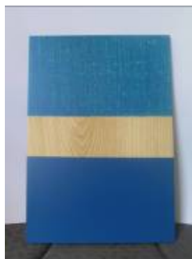
Oberflächenstörung (Refüsieren) in Wasserlacken auf einer PVC-beschichteten Messebauplatte (rechts) und einem mit Wachspolitur behandelten Fichtenholz (links): Behebung der Störung durch Zugabe von 1% Antisilikon wv zum Lack!
