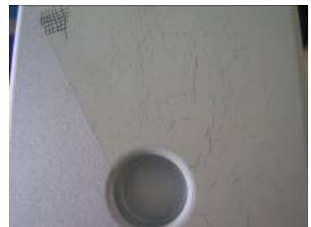
Lösemittelangriff einer 2K-Epoxygr. Ism. auf einem ABS-Bauteil!
