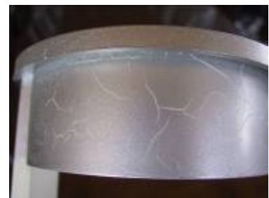
Lösemittelangriff von RUCOPUR Metalisé auf einem Polystyrol-Lampenhalter! auf einem Makrolon-Bauteil!
