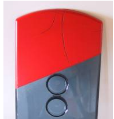
Lösemittelangriff von ATAPUR 2000 auf einem Makrolon-Bauteil!
