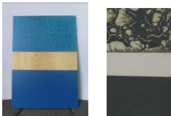
Oberflächenstörung (Refüsieren) in Wasserlacken auf einer PVC-beschichteten Messebauplatte (rechts) und einem mit Wachspolitur behandelten Fichtenholz (links): Behebung der Störung durch Zugabe von 1% Antisilikon wv zum Lack!
