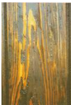
Schichtbildung der KH-Lasuren auf den Hartholz zonen führte bei der Bewitterung zu Ablätterungen (v.a. bei Tangentialschnitten).
